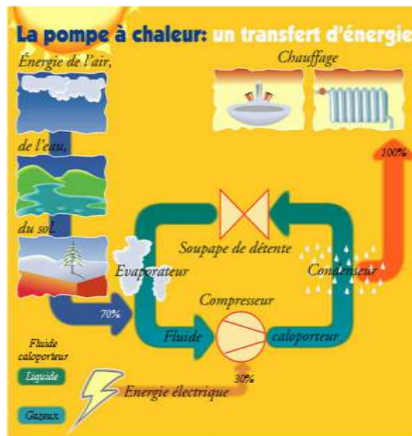
Figure 51 : principe de fonctionnement des pompes à chaleur (source www.airclim-concept.com )
